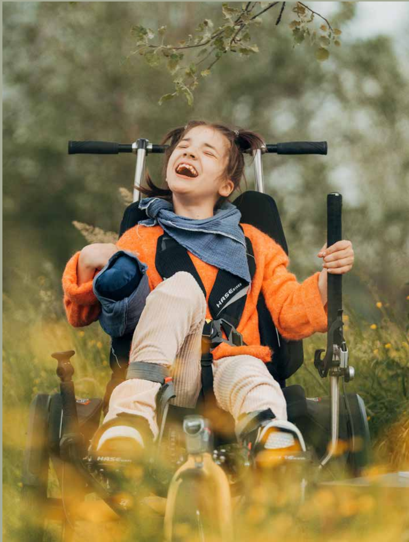
Vélo thérapeutique Trix à guidon bas : cadre télescopique, poids réduit de 21 kg, avec dérailleur Shimano Nexus à 8 vitesses et freins à disques mécaniques.
