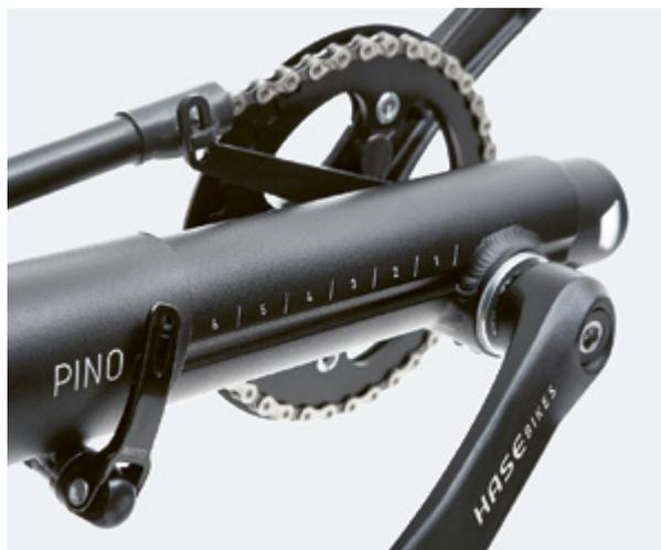
Robuste, le guidon est formé par matriçage. Il est doté de butées réglables pour conserver les préférences au niveau des angles et inclinaisons, et une seule vis suffit à le libérer. Il peut alors se rabattre en arrière en position de transport. Siège avant déposé et cadre rentré au maximum, le PINO prend place sur n'importe quel porte-vélos usuel. Et, du coup, sur quasiment toutes les voitures !
