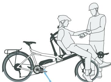
> Même chargé, le PINO est parfaitement stable sur sa béquille double. Aussi, le pilote est pleinement disponible pour aider l'équipier à s'installer ou à mettre pied à terre..
