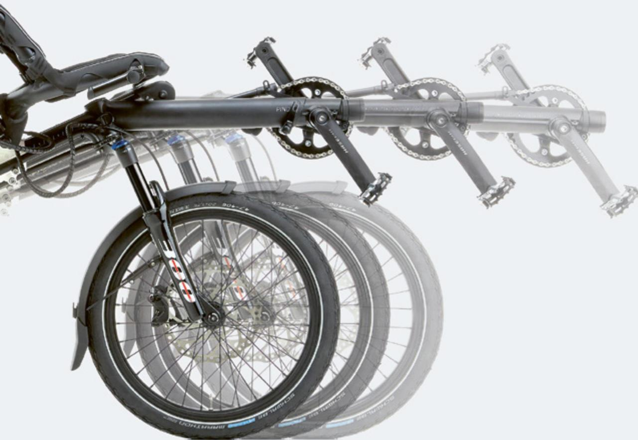
Le nouveau PINO se dote d'un cadre télescopique. En clair : pour réduire l'empattement, il suffit de rentrer la partie avant du cadre dans la poutre principale. L'avantage ? Avoir par exemple un vélo cargo avec l'agilité et l'empattement d'un vélo urbain usuel. Ou une navette parentale qui se fasse petite dans les caves, les garages et autres espaces exigus. Ou un tandem avec l'empattement d'un VTT 29 pouces, qui prenne place sur n'importe quel porte-vélo arrière. Atout de taille !
