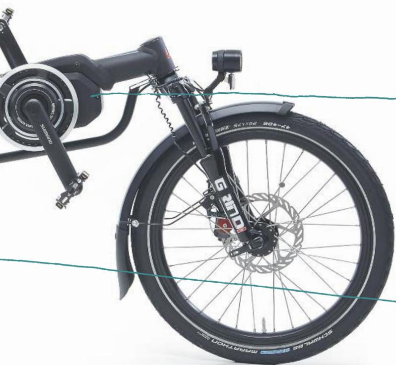
Empattement : 132 – 178 cm · **Cadre** : aluminium 7046 · Bôme : aluminium 6061 T6 · Charge maxi : 140 kg · Poids : 32,5 kg
