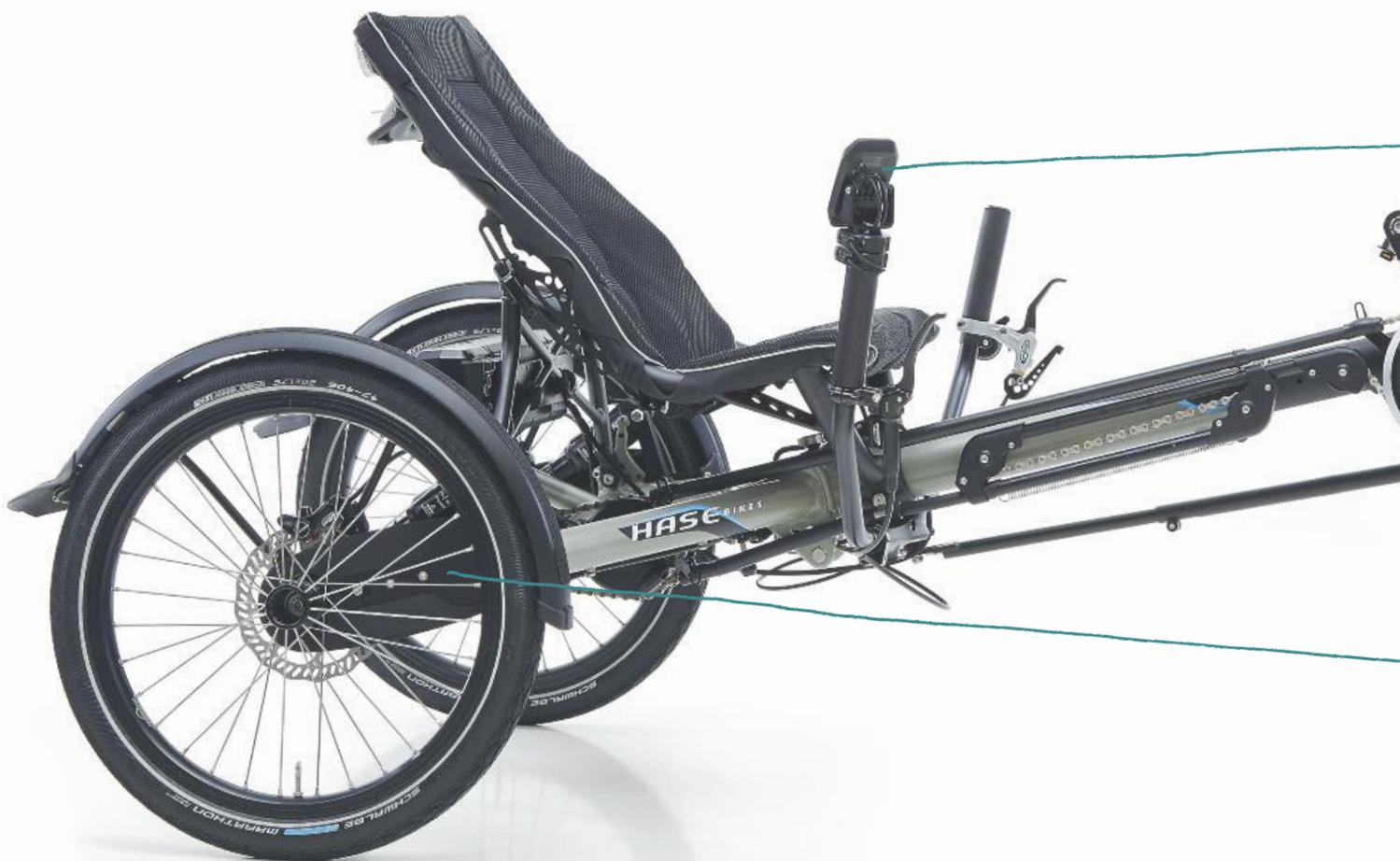
**EVO STEPS – Dimensions et équipement :** Longueur totale : 176–221 cm (sans roue AV 153 cm) · Largeur totale : 90 cm · Hauteur totale : 82 cm, siège rabattu : 53 cm · Hauteur d'assise : 50 cm · Hauteur de pédalier : 52 cm · Fourche suspendue : Spinner Grind 1 · Mécanisme de pliage : mécanisme HASE BIKES, Dimensions plié : 96 × 90 × 49 cm · **Suspensions :** indépendantes HASE BIKES EVO avec antiroulis et amortisseurs pneumatiques · **Freins :**
