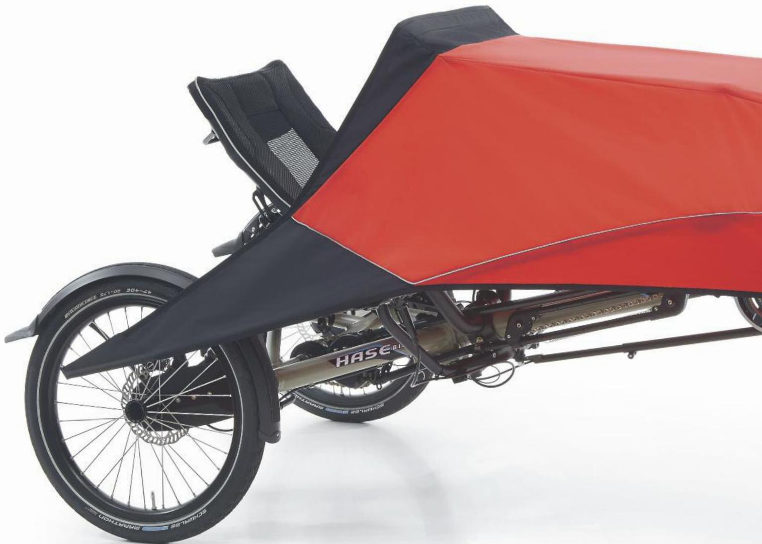
**Équipement EVO STEPS** (suite) : **Roues** : 20" - Moyeux arrière : HASE BIKES QUICKSTICK - Jante : double paroi, à œillets - Rayons : Sapim - Pneus : Schwalbe Marathon 47 x 406 - **Vitesses** : Moyeu 8 vitesses Shimano Alfine Di2 - **Pédalier** : Batterie : Li-Ion, 504 Ah, 36 V, autonomie 80 km env. - **Éclairage** : Batterie moteur - B & M Toplight Flat Plus - Phare avant : B & M IQ-X 100 Lux, feu de position - **Coloris** : Gris béton mat RAL 7023 / poudre thermolaquée - **Accessoire** :
