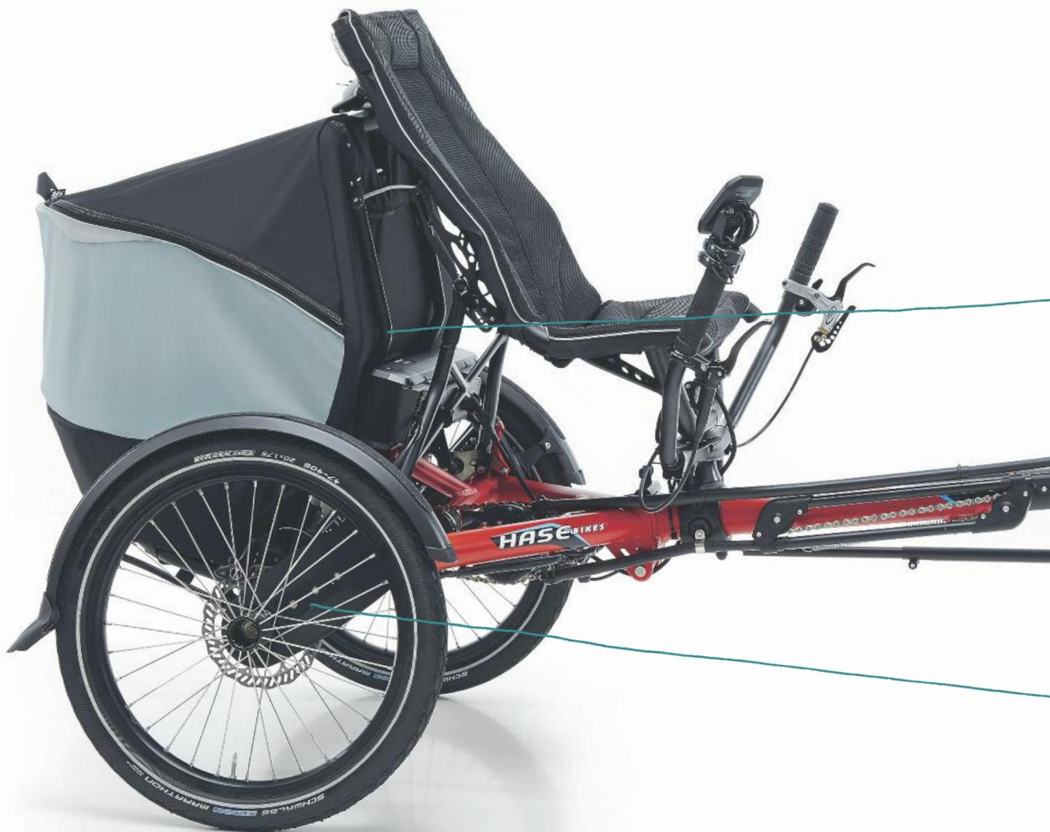
**LEPUS STEPS – Équipement :** Cadre : alu · Charge maxi : 140 kg · Poids : 30,5 kg · Fourche : 16" · mécanisme de pliage HASE BIKES, dimensions plié : 96×90×54 cm · **Suspensions :** indépendantes HASE BIKES EVO, avec antiroulis et amortisseurs
