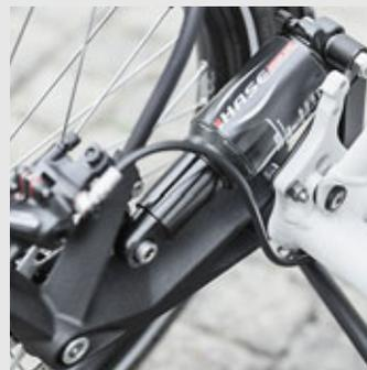
feeling KETTWIESEL reste intact et que le roulis reste aux abonnés absents. Les amortisseurs à air comprimé sont réglables selon le poids du pilote et celui du chargement : même avec beaucoup de bagages, confort de pilotage et sécurité répondent toujours présent.
