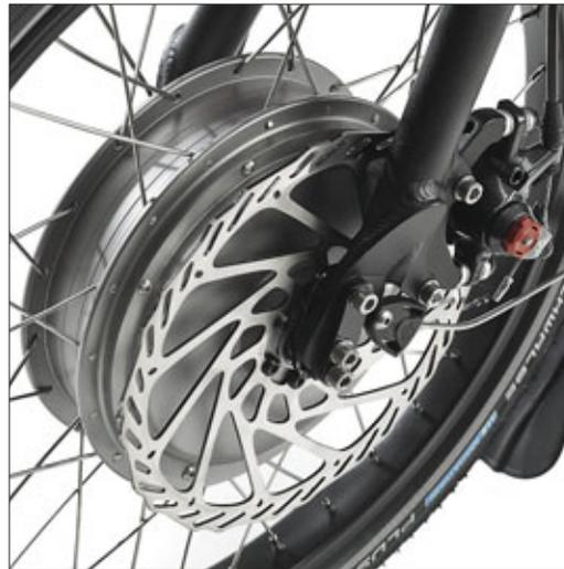
500 watts à l'avant, deux pédales, 45 km/h. Ça a l'air tout bête. La différence avec d'autres approches du trajet pendulaire : ça marche et le plaisir est en prime. La poignée au guidon détermine la quantité de jus à mettre dans le moteur-moyeu. Vous décidez si vous pédalez et avec quelle intensité.
