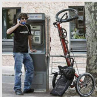
rapide du cadre permet un réglage à la longueur de jambes encore plus simple, la chaîne est quant à elle presque entièrement protégée... tout comme le pantalon. Pour le transport, le siège est rabattu d'un geste, les roues se déposent d'une pression sur le moyeu. Et pour stationner, le KETT sait faire beau...
